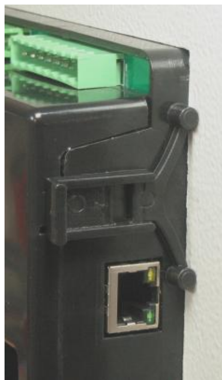
Установка самоудерживающегося кронштейна
